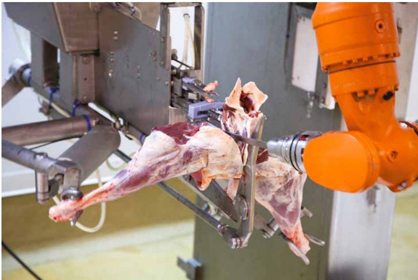
Pierwsze zadanie polegało na automatycznym (zrobotyzowanym) odkostnieniu tylnej ćwiartki jagnięcia - oddzieleniu dwóch nóg od kości skokowej."
