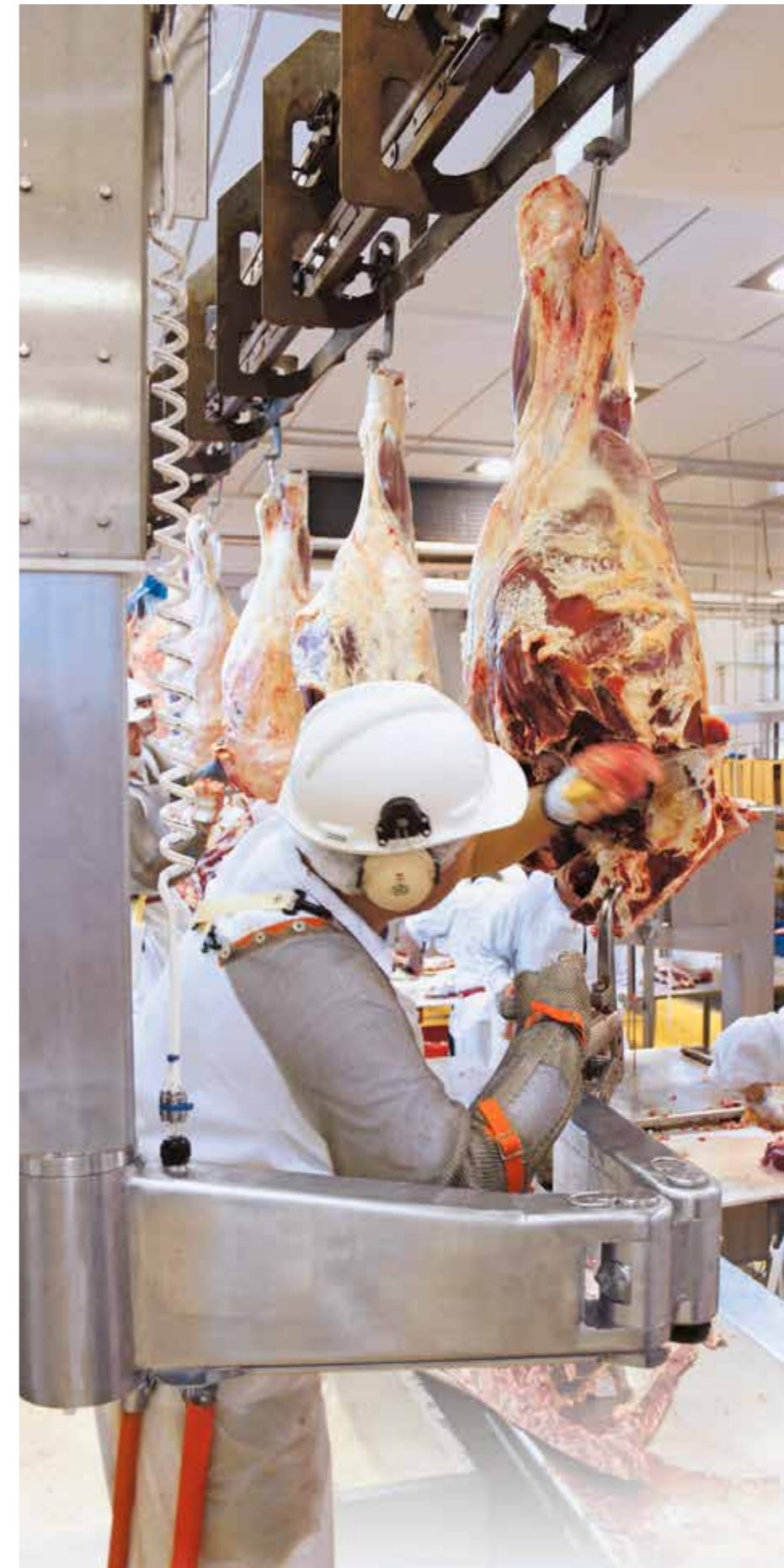
Urządzenie do trybowania mięsa wołowego eliminuje konieczność silnego ciągnięcia podczas trybowania kości śródreżca i golonek wołowych."
