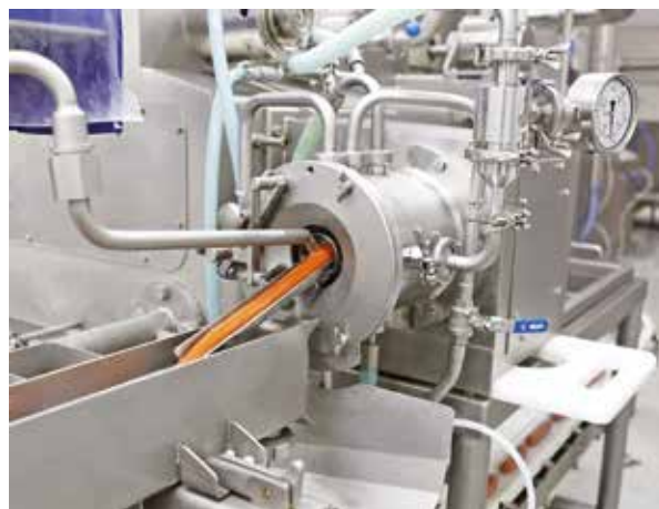
Rys. 7. W linii, w pełni zautomatyzowana koekstruzja osłonek wędliniarskich.
