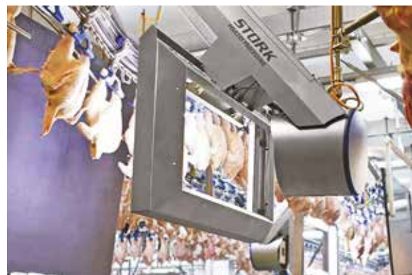
Rys 3. System analizy obrazu do klasyfikacji i sortowania brojlerów.
