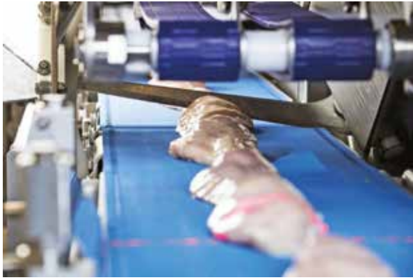
Rys 2. Porcjowanie mięsa sterowane komputerowo z wykorzystaniem automatycznego ważenia i skanowania laserowego (patrz czerwona linia z przodu) w celu uzyskania bardzo dokładnych mas docelowych przy bardzo dużej prędkości (do 700 plasterków / min). Dzięki uprzejmości Marel.
