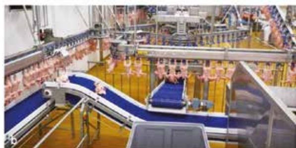
Rysunek 1. (a) w pełni zautomatyzowana linia do formowania, zdolna do produkcji 200 000 identycznych nuggetsów na godzinę; b) automatyczne sortowanie na linii w zakładzie przetwórstwa świeżego drobiu. Dzięki uprzejmości Marel.
